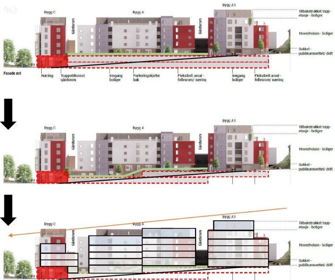
Figur 1: Innspill fra Byarkitekten til "saksing" for å oppnå bedre tilknytning til omkringliggende gateløp (SE arkitektur).
