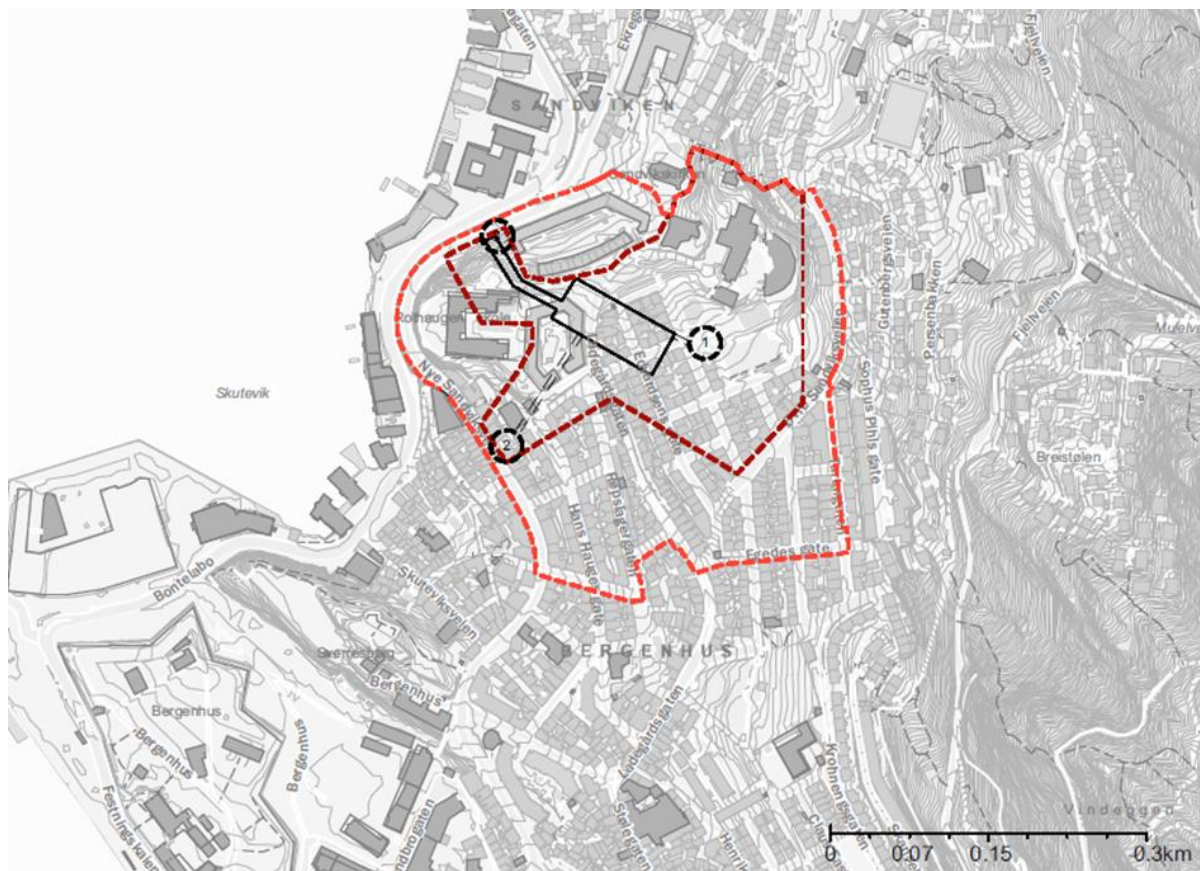
Figur 4: Plangrenser med tentativ plassering fjellhall og adkomster. Plassering av fjellrom kan justeres, så lenge krav til overdekning, avstand/nærføring, mm. kan oppfylles. (Opus)
