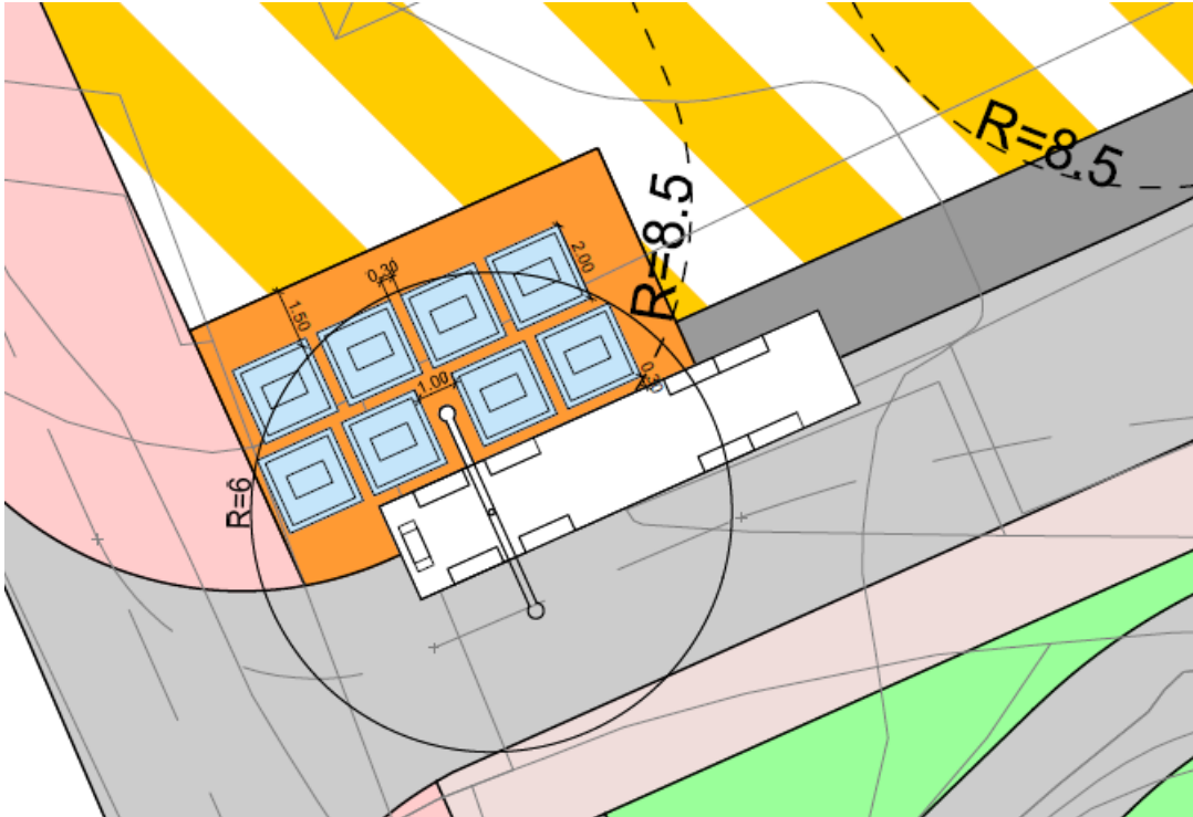
Figur 17: viser oppstillingsplass for renovasjonskøyretøy.
